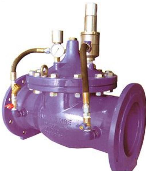
شیرهای اطمینان همانطور که از نامشان مشخص است برای جلوگیری از بالا رفتن فشار خط لوله از فشار مجاز استفاده می‌شوند و در صورتیکه فشار خط لوله از فشار تعیین شده زیادتر شود، پیلوت عملکرد و شیر را باز می‌کند و فشار مازاد خط از طریق شیر اطمینان تخلیه می‌شود و پس از رسیدن فشار خط لوله به فشار مجاز پیلوت بسته شده و موجب بسته شدن شیر می‌شود.
