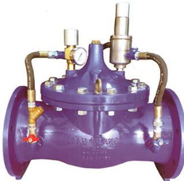
شیرهای ثابت نگه دارنده فشار، برخلاف شیرهای فشارشکن، فشار بالادست را همواره دریک مقدار مشخص و تعیین شده نگه می دارد. این شیرها در صورت افزایش فشار خط از فشار تعیین شده، باز شده و فشار مازاد رابه خط لوله تخلیه می کنند و در زمانی که فشار بالادست از میزان تعیین شده کمتر باشد، تماماً بسته می شوند تا فشار بالادست به فشار مدنظر افزایش یابد.
