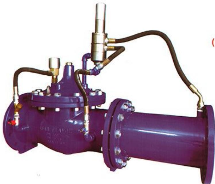
شیرهای کنترل دبی دارای سیستمی متفاوت تر از سایر شیرهای کنترلی اتوماتیک پیلوت دار هستند که در آنها از یک اریفیس برای تبدیل سرعت به فشار استفاده می‌شود و فشار پشت و جلو اریفیس توسط پیلوت سنس می‌شود و از طریق نسبت به بستن شیر در زمان بالارفتین سرعت جریان و باز کردن شیر در زمان کاهش سرعت جریان استفاده می‌شود تا بدین صورت دبی مدنظر را ثابت نگه دارند.
