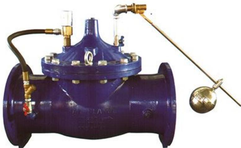
این نوع شیر جهت کنترل آب مخزن در محدوده مورد نظر بکارمی رود. عملکرد این شیر توسط مکانیزم شناور نصب شده داخل مخزن کنترل می شود. به اینصورت که با کاهش سطح آب مخزن از میزان تعیین شده شیر باز شده و آب وارد مخزن می شود تا سطح آب مخزن به حد مورد نظر بررسد که در این موقعیت شناور عمل کرده و شیر رامی بیندد.
